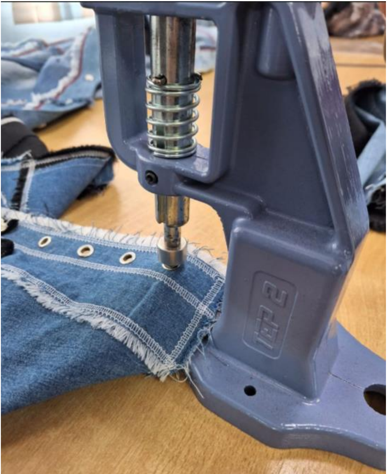
Приложение Ц Установка люверсов на топ
