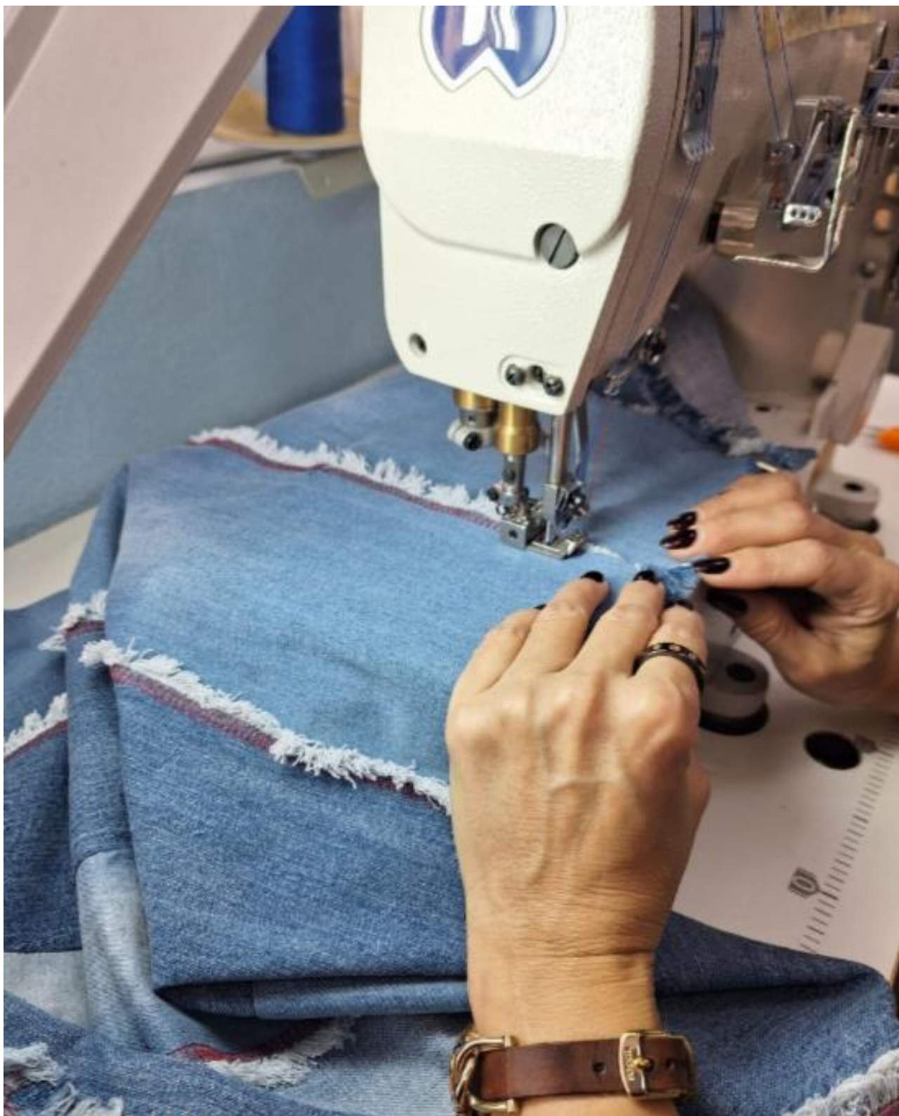
Приложение Ч Обработка бокового шва
